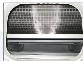
Micretela in Acciaio INOX e lame raschianti rendono l'impianto autonomo riducendo le manutenzioni.
